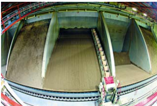
»5 The line-A longitudinal-dredging excavator, type EKBL 14.5 / 45/ 4 »5 Längsbagger der Linie A Type EKBL 14,5 / 45/ 4
