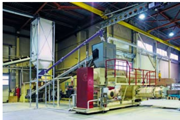
»6 Combined de-airing extrusion unit Futura II comprising a type-MDVG 1025f de-airing double-shaft mixer and a type-E 65a/56 extruder »6 Vakuomaggregat Futura II bestehend aus Vakuumdoppelwellenmischer Type MDVG 1025f und Extruder Type E 65a/56
